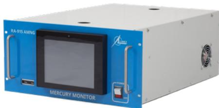
O **RA-915AM** foi projetado para a medição contínua da concentração de mercúrio no ambiente e ar interior, em hidrocarbonetos e em gases de processo. Este monitor autônomo possui a maior sensibilidade e seletividade e é otimizado para medições contínuas sem supervisão a longo prazo. Não são necessários gases comprimidos.
